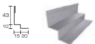
PROFILO | PROFILE a "C" con intaglio per doghe B15 with carving for B15 staves 20x50x20 L=4000 mm
