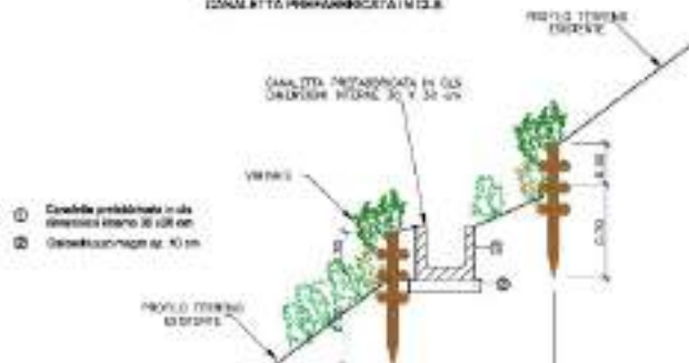
TIPOLOGIA 2 CANALITTA PERMANENTE IN C.C.
